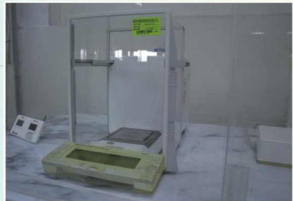
微量電子天平 分析項目:粉塵等重量分析
