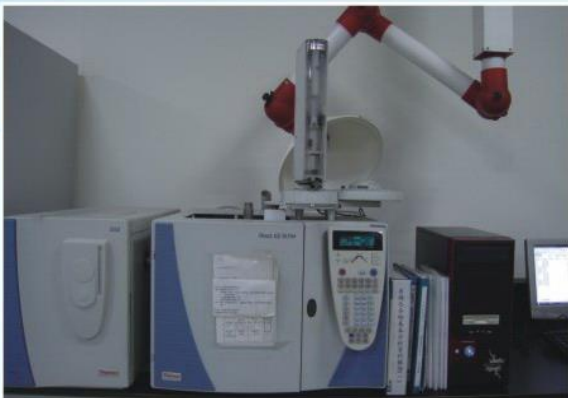
GC/MS 氣相質譜儀 分析項目:揮發性有機化合物
