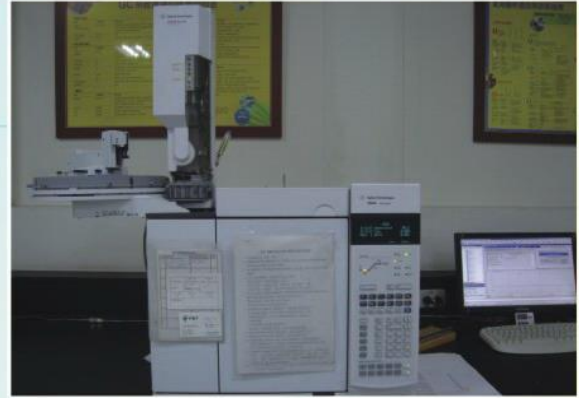
GC-7890 氣相層析儀 分析項目:揮發性有機化合物
