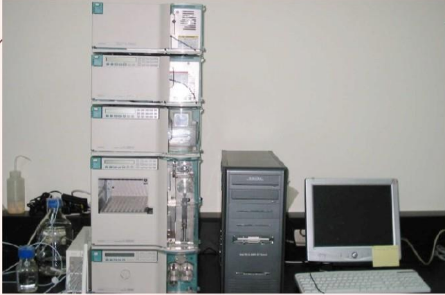
HPLC 液相層析儀 分析項目：分散性染料、偶氮等
