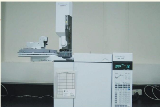
GC-7890 氣相層析儀 分析項目：揮發性有機化合物
