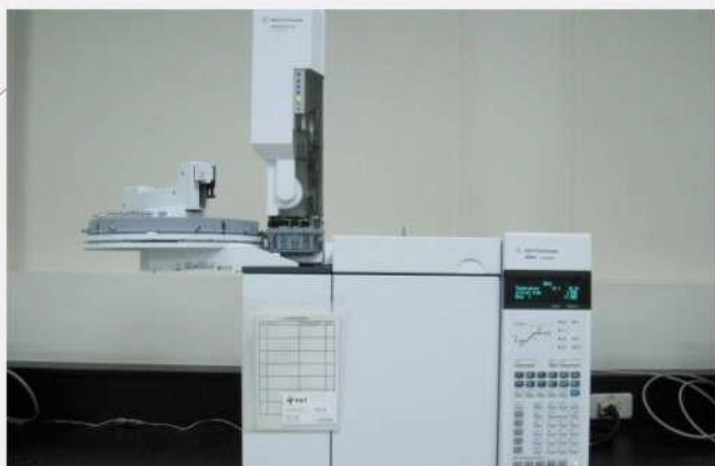
GC-7890 氣相層析儀 分析項目：揮發性有機化合物
